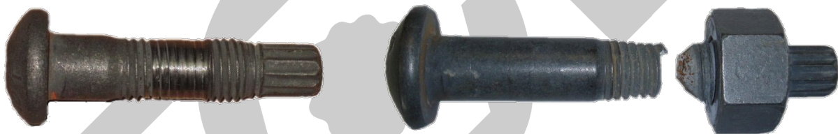
Exemple de fillet décapé
